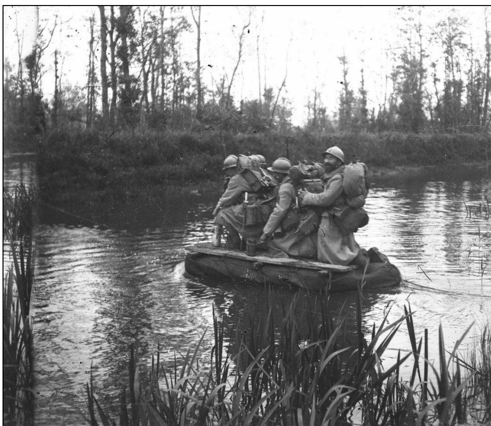
Traversée d'une rivière sur un radeau réalisé avec des sacs Habert. Ces sacs furent utilisés pour le franchissement de la Meuse. Photo ECPAD.
